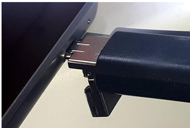
19. ábra A tablet micro-USB portja annak alsó szegélyoldalán található. Figyelni kell a helyes csatlakoztatási pozícióra
