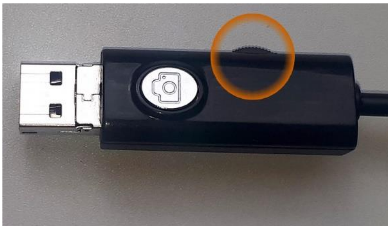
20. ábra A kamera LED-izzóinak erejét a körrel jelölt tekerő-gomb segítségével szabályozhatja
